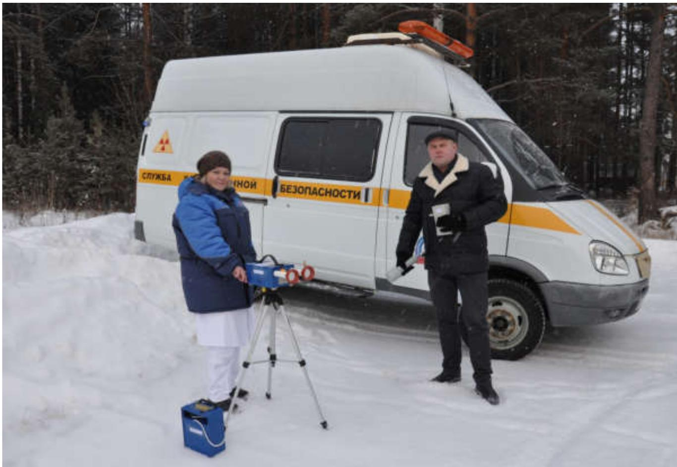
загрязнения окружающей среды радионуклидами при любом направлении выброса в сторону ближайших населённых пунктов: г. Лесной, г. Нижняя Тура, г. Качканар и с постоянной регистрацией мощности дозы гамма-излучения. АСКРО осуществляет контроль: мощности эквивалентной дозы гамма-излучения, объемной активности альфа-, бета-излучающих радионуклидов, температуры и влажности воздуха, атмосферного давления, скорости и направления ветра.
